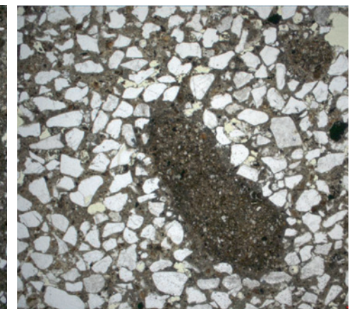
figuur 6. Detail van een legmortel van de Veeartsenijsschool in Anderlecht (1903-1909). De kalkmortel werd aangemaakt met fijn kwartzand en vertoont in dit monster enkele kalknodules.
