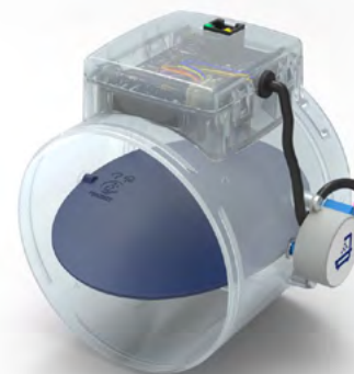
Debietregelaar voor centrale afzuiging, uitgerust met detector (H 2 O en/of VOS, of CO 2 ) © Renson
