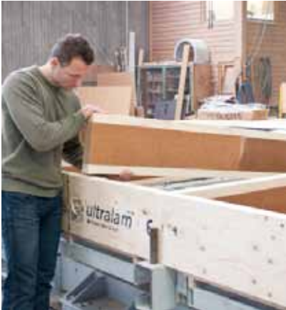
Prefabricage van wandelementen met STEICO LVL R en STEICO wall
